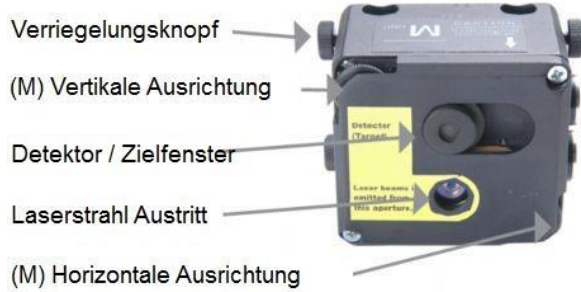
Abb. 1a: Vorder- und Oberansicht Messaufnehmer
