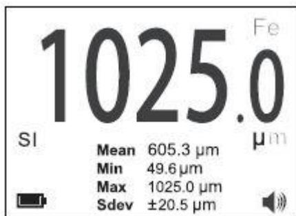
Wenn die Messung sich außerhalb der Alarmgrenzen befindet, piept das Gerät dreimal um dies zu signalisieren.
