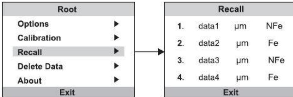
Um die Daten zu löschen, drücken Sie **MENU** lange. Bewegen Sie sich dann über das Hauptmenü zum Optionsmenü auf den Menüpunkt „Datenlöschung“. Dort können Sie mit **DATA** zwischen „Einzellöschung“ (Löschung einzelner Daten) und „Gesamtlöschung“ (Löschung aller Werte auswählen).
