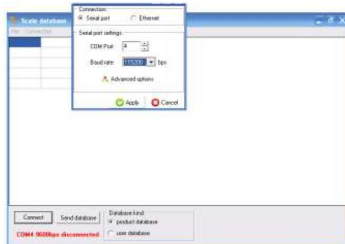
Die Einstellungen mit „Apply“ Button bestätigen. Nun erfolgt die Verbindung zwischen dem PC und der Waage (unten links grün).
