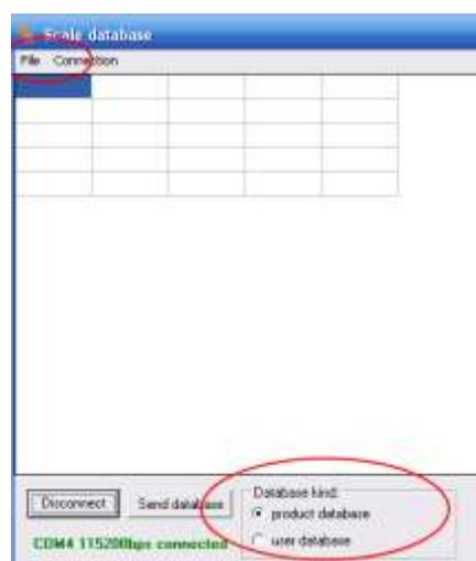
Erscheint bei der Auswahl einer Datenbank der Fehler „I/O error 32“ so ist diese Datenbank ggf. noch geöffnet. Schließen Sie die Datenbank und versuchen es erneut.
