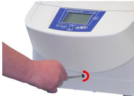
Abb. 11: Manuelle Entriegelung des Deckelschlosses
