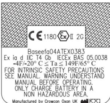
1. Das Gerät darf in den Zonen 1 und 2 mit den Versionen für brennbare Gase und in den Zonen 0, 1 und 2 mit den toxischen und sauerstoffmessenden Versionen für Gruppe IIA-, IIB und IC-Gase und -Dämpfe für die Temperaturklassen T1, T2, T3 und T4 eingesetzt werden.
