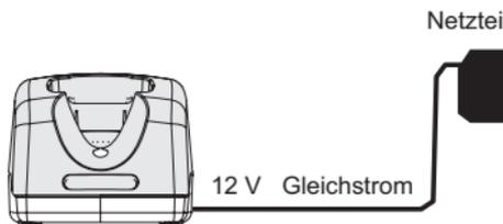
Der Gasman muss zum Laden normalerweise ausgeschaltet werden. Während des Ladens leuchtet die rote LED auf der Vorderseite des Ladegeräts. Wenn der Ladevorgang beendet ist erlischt die rote LED.
