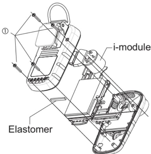
3. Legen Sie den Gasman mit der Vorderseite nach unten auf einer ebenen Oberfläche ab.5. Unpack the new i-module and carefully clip it into the support clip.
