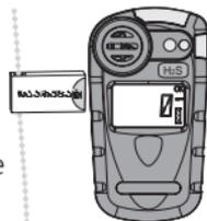
Gasman-Gerät aktiviert den Gastest und zeigt „TEST“ auf der Anzeige an.
