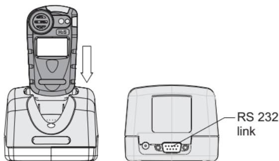
Mithilfe der Software kann der Anwender Alarmstufen und Betriebsweisen konfigurieren, Kalibrierungen durchführen, Berichte ausdrucken und die Daten- und Ereignisprotokolle einsehen.
