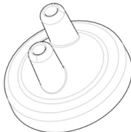
1. Zum Anbringen der Ansaugkappe müssen Sie zuerst sicherstellen, dass die Kappendichtung intakt ist. Schieben Sie dann die Ansaugkappe über den Sensor an der Vorderseite des Gasman, bis die Kappe fest an ihrem Platz sitzt.
