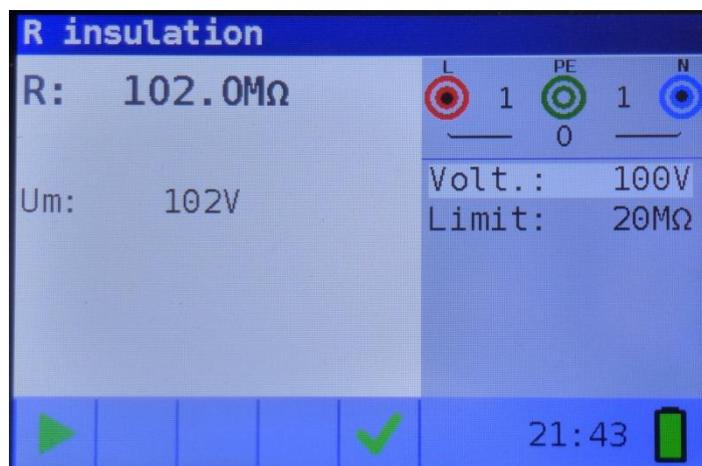
Figura 5-3: Ejemplo de resultados de la medición de la resistencia del aislamiento
