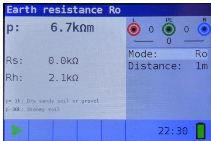
Figura 5-52: Ejemplo de resultados de la medición de la resistencia específica de tierra
