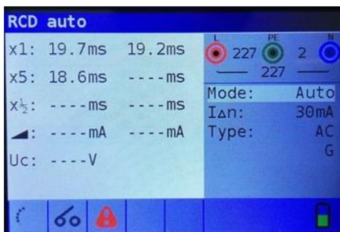
Figura 5-22: Resultados de la prueba automática de RCD del paso 3
