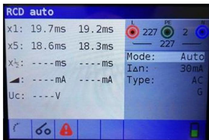
Figura 5-23: Resultados de la prueba automática de RCD del paso 4
