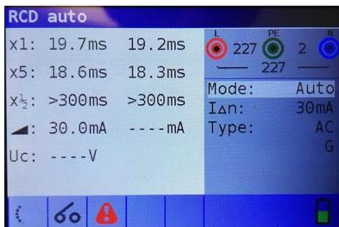
Figura 5-26: Paso 7 Resultados de la prueba automática de RCD
