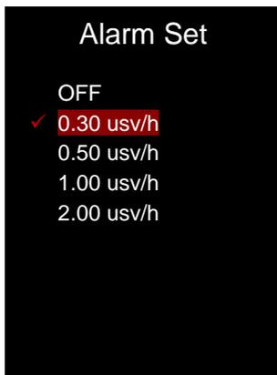
Seleccione con las teclas de flecha arriba y abajo el umbral. Confirme con la tecla ON/OFF. Una vez que haya ajustado el umbral de alarma, pulse la tecla izquierda (historial) para volver al menú principal.
