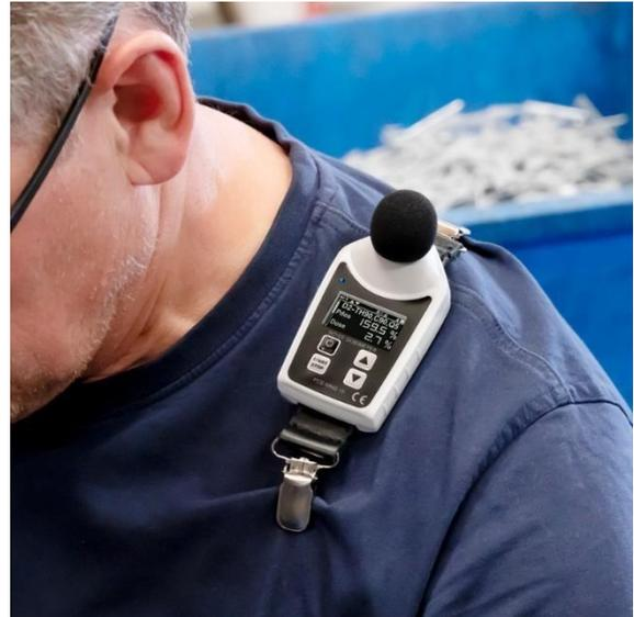
El dosímetro compacto PCE-MND 10 de PCE Instruments es adecuado tanto para mediciones de nivel de ruido como de dosis de ruido. Cumple todos los requisitos de la norma IEC 61252, una norma internacional para dosímetros acústicos personales. A pesar de una cantidad excepcionalmente grande de datos de cálculo para los valores sonoros registrados, es fácil de manejar antes, durante y después de la medición.
