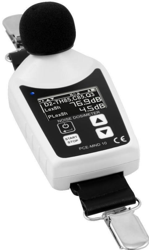
A pesar de su pequeño tamaño, el registrador de datos de sonido está equipado con una pantalla y cuatro botones de control. Esto significa que los valores determinados pueden comprobarse ya durante la medición y que los ajustes importantes también pueden modificarse directamente en el aparato.
