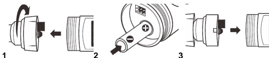
1. Desenrosque la tuerca de unión del electrodo y extraiga el electrodo de la carcasa, teniendo en cuenta la alineación correcta.
