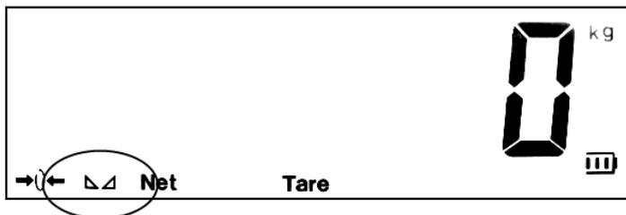
Si la balanza no reacciona, compruebe que la pantalla recibe la alimentación correctamente. Si el indicador de estabilidad no aparece en la pantalla, revise la superficie sobre la que ha colocado la balanza y colóquela bien.
