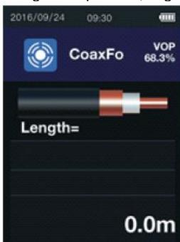
Modo de medición para cables coaxiales y cables conectados al dispositivo mediante los adaptadores de medición.
