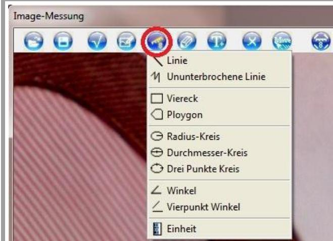
**Medición:** Después de que se haya realizado una calibración, se puede utilizar el microscopio para mediciones en la imagen. Seleccione para ello un objeto adecuado (p.ej. círculo de tres puntos) y marque los puntos de medición en la imagen. El resultado de medición se indicará. Mediante un clic con el ratón se puede indicar el resultado en la imagen.
