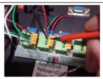
Después de cada sujeción, mueva ligeramente los cables para comprobar si están suficientemente apretados. Las conexiones de cables flojos pueden causar mediciones defectuosas.
