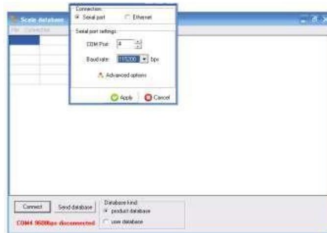
Confirme los ajustes con la tecla "Aplicar". Ahora se establece la conexión entre el PC y la balanza (verde en la parte inferior izquierda).
