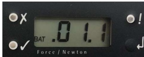
Abb. 3.3: Anzeige des BAT-Indikators
