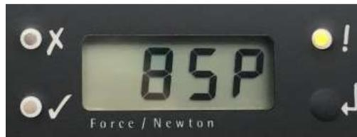
Abb. 3.2: Anzeige des Batterieladezustands
