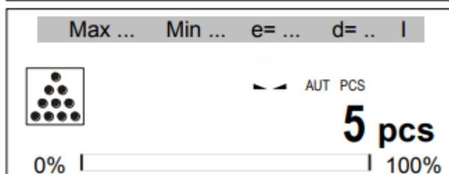
La balanza muestra la cantidad de piezas. Ponga una porción de piezas. Para finalizar el trabajo con la función pulse la tecla MENU, seleccione *Applications*, después *PCS* y *Deactivation*.
