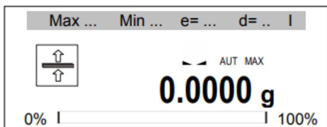
Al presionar la tecla  $\rightarrow T \leftarrow$  se produce la puesta a cero de la balanza y permite iniciar la siguiente serie de pesaje.
