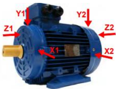
Imagen 11: lugares de medición en motores eléctricos
