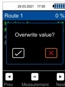
Fig. 21 Sobrescribir la medición de un punto de medición para la medición de la ruta actual
