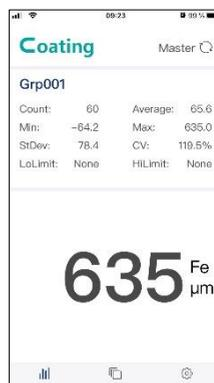
En la pestaña "Group", se muestran los datos de medición almacenados en el medidor. A través de la función "Export", se pueden guardar los datos en el dispositivo móvil formato CSV, PDF y también como un archivo TXT.
