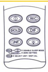
REC Accionando la tecla REC comenzará el modo de grabación de los valores MAX o MIN. Volviendo a accionar la tecla: lectura del valor MAX > lectura del valor MIN > indicador del tiempo de medición trascurrido en la parte inferior derecha de la pantalla. Aunque no se visualice, el tiempo de medición sigue trascurriendo mientras se indican los valores MAX o MIN. Manteniendo presionada la tecla REC durante 3 segundos se regresa al modo normal.
