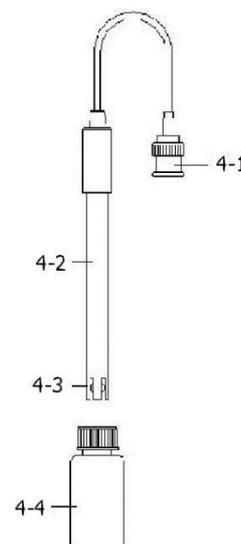
**Nota:** La primera vez que conecta el electrodo de pH al medidor, debe de calibrarlo. El procedimiento de calibración se describe en detalle en el capítulo 4.4.
