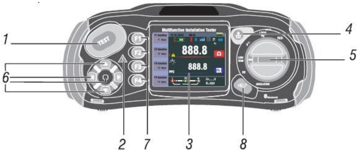
1. Inicia la prueba seleccionada. La tecla **T** está rodeada de un „Touch Pad“. El Panel táctil mide el potencial entre el usuario y el terminal PE del aparato de prueba. Si sobrepasa el valor umbral de 100V, se ilumina el símbolo **D** sobre el „Touch Pad“.
