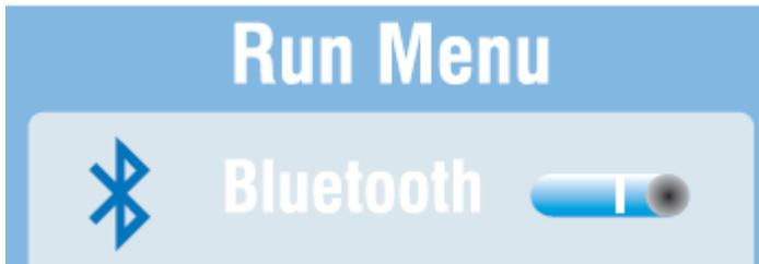
Pulse ◀ o ▶ para encender o apagar Bluetooth, pulse la tecla ESC para salir del menú o guardar.
