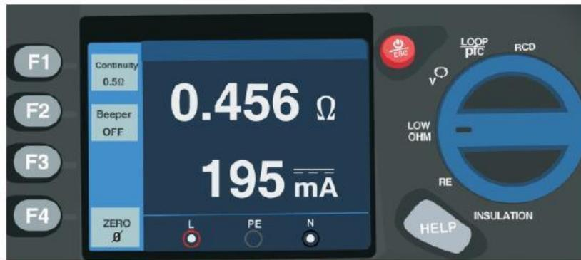
La prueba de continuidad se utiliza para comprobar la integridad de las conexiones, realizando una medición de resistencia de alta resolución. Esta prueba es importante para comprobar la protección de las conexiones de puesta a tierra.
