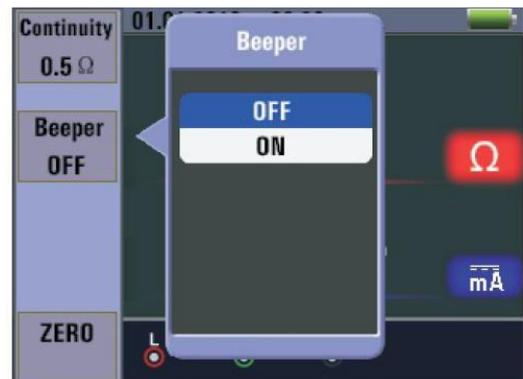
**Tecla F1:** Pop-up y apagado del menú de baja impedancia. El modo apagado está activado cuando el usuario lo selecciona. El menú desaparece si se pulsa repetidamente la tecla F1.
