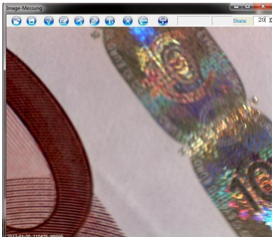
(6) Ahora lea en el aparato el nivel de ampliación e introdúzcalo en el campo "Skala". El valor de escala sirve como referencia para mediciones que se realicen posteriormente con el programa.
