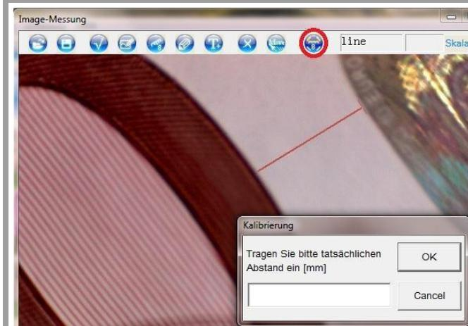
**Calibración:** Aquí puede realizar la calibración. Necesita una imagen, en la que se conoce la distancia o la regla de calibración adjunta. Esta distancia se marca en la imagen e introduce en la pantalla de entrada el valor en milímetros.
