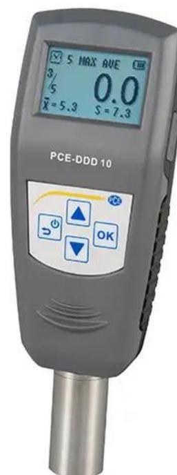
O durômetro (Shore D) para termoplásticos é utilizado tanto como aparelho de mão para medir in situ como para verificar o material em um laboratório. O durometro dispõe de um componente de medição com sensor e uma tela digital com uma precisão de leitura de 0,1 unidades de dureza.
