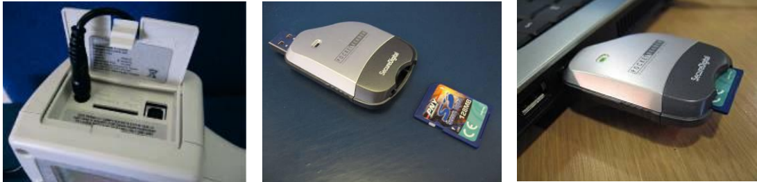
Bild 4 SD-Karte entnehmen und in den Leser einlegen
