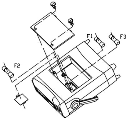
Bevor Sie die Sicherungen Wechseln, trennen Sie das Messgerät vom Netz sowie vom Prüfobjekt und entfernen gegebenenfalls die Batterien. Die Sicherung F1 ist an der Rückseite des Gerätes über dem Netzeingang angeordnet. Die Sicherungen F2 u. F3 befinden sich unter dem Staufach an der Oberseite des Gerätes. Zum Wechsel der Sicherungen verfahren Sie wie im Bild beschrieben Ersetzen Sie die Sicherungen nur durch Sicherungen gleichen Typs und gleicher Stärke.
