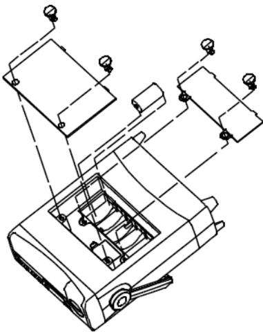
Zum Batteriewechsel trennen Sie das Messgerät vom Netz sowie vom Prüfobjekt. Das Batteriefach befindet sich unter dem Staufach an der Oberseite des Gerätes. Zum Wechseln oder einlegen der Batterien öffnen Sie wie im Bild beschrieben das Staufach und die Batteriefachabdeckung. Um das Gerät mit Batterien zu betreiben Schalten Sie den **Power Input** Schalter auf der Rückseite des Gerätes auf **DC**.
