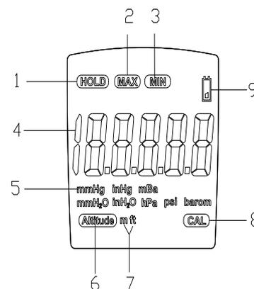
**Bedienung des Druckmessgerätes PCE-APM 30:**
